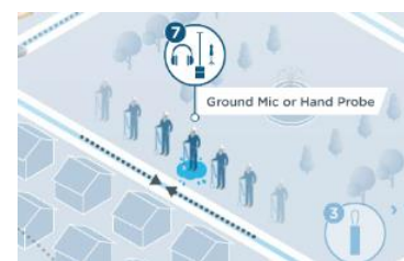
7. Localización de fugas mediante micrófonos acústicos
