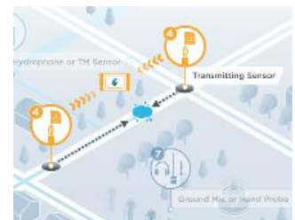
4. Detección de fugas punto a punto mediante un correlador en línea
